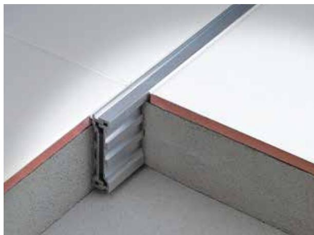
Giunto tecnico di dilatazione in metallo per posa a malta a scorrimento. Offre caratteristiche di elevata resistenza ai carichi e di durata nel tempo, assicurando sempre un gradevole impatto visivo. Compensa dilatazioni e contrazioni dei pavimenti adiacenti grazie allo scorrimento delle due parti metalliche una nell'altra per  $\pm 2$  mm. Profilo completo non assemblato. Assemblare gomma-schiuma solo prima della posa.
